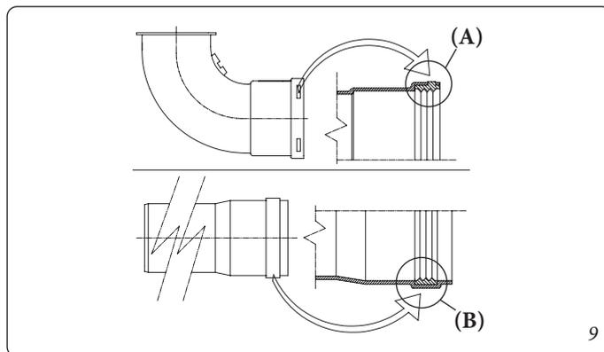
• **Posizionamento delle guarnizioni (di colore nero) per fumisteria "serie verde".** Prestare attenzione ad interporre la guarnizione corretta (per curve o prolunghe) (Fig. 9):
