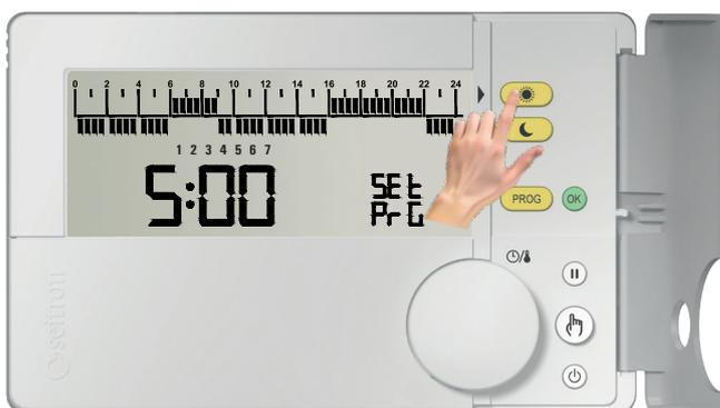
Premere "☀️" per impostare la **modalità di comfort** (sulla barra dell'istogramma temporale viene visualizzato il segmento sulla fascia superiore).
