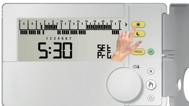
Premere ancora "☀️" per impostare la **modalità di comfort** (sulla barra dell'istogramma temporale viene visualizzato il segmento sulla fascia superiore).
